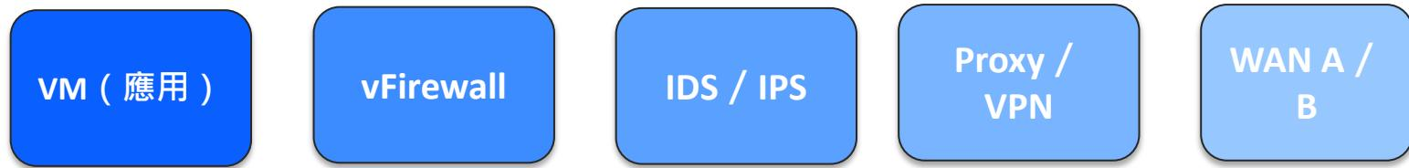
フロー: VM（応用） → vFirewall → IDS / IPS → Proxy / VPN → WAN A/B 。各ノードに対応するSecurity PolicyとLogを適用でき、最小権限かつ可監査なService Chainを形成します。
